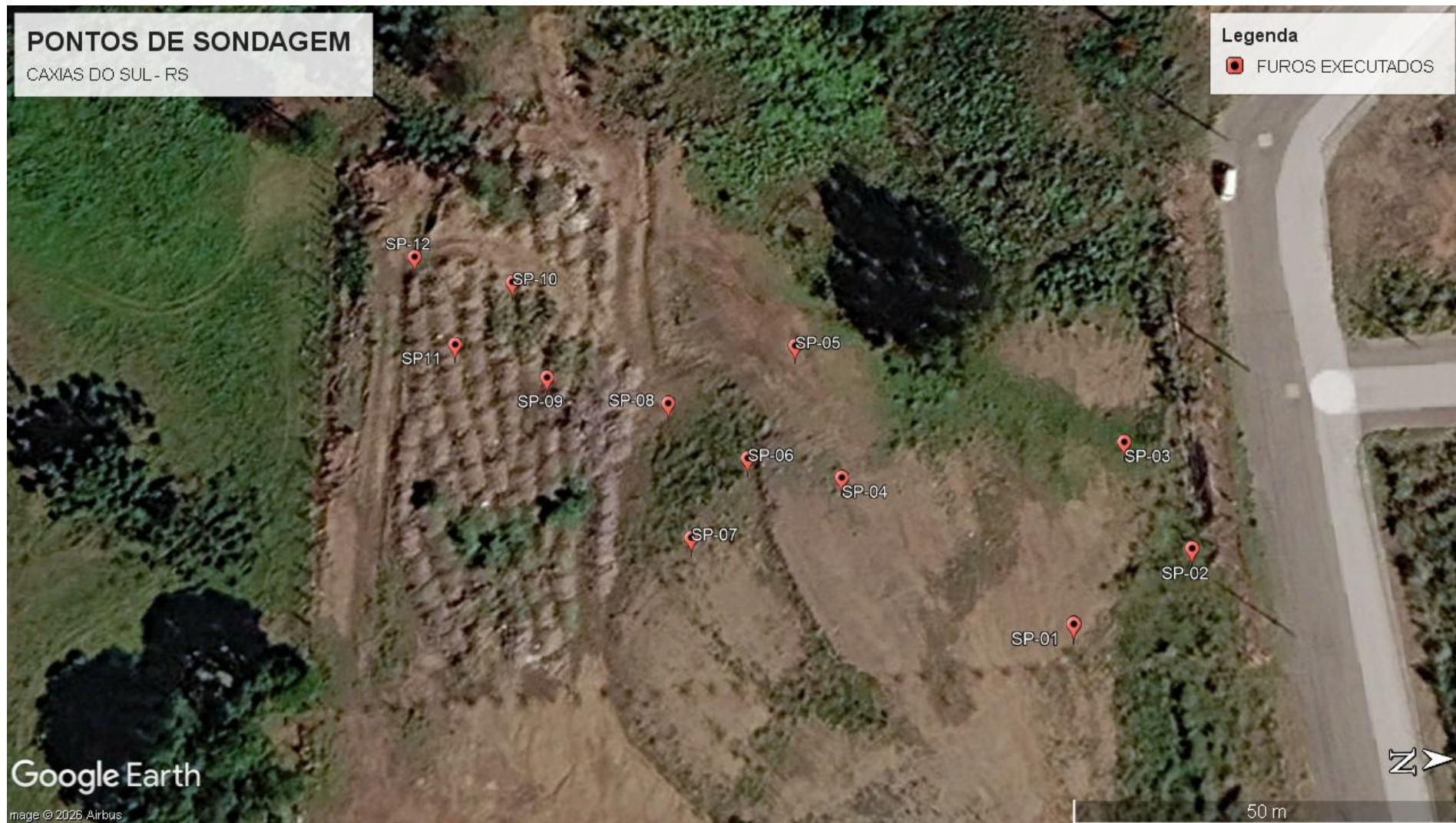
Figura 1 – Localização dos Furos Executados
