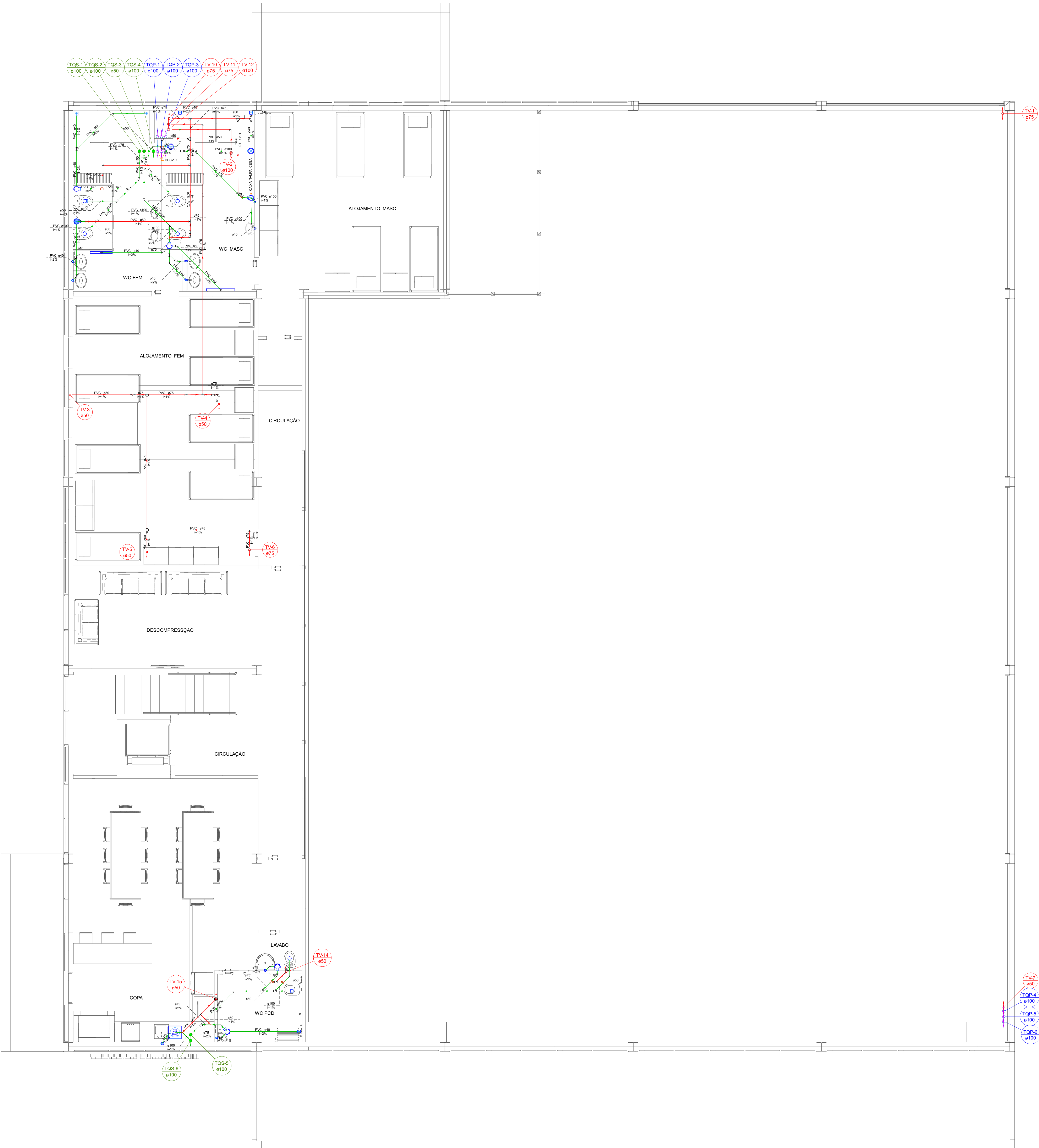
PLANTA BAIXA SUPERIOR - CENTRO LOGÍSTICO - ESGOTO 1:50
