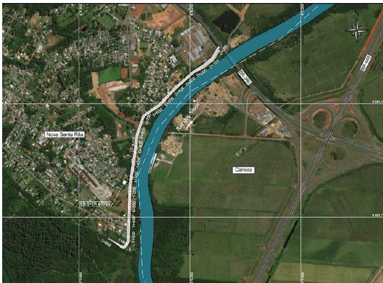
Figura 80 - Dique de proteção em Nova Santa Rita na margem direita Fonte: Consórcio Metroplan Bacia do Rio dos Sinos
