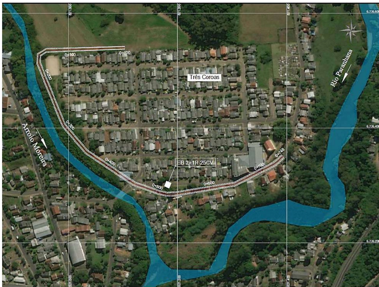
Figura 103 - Dique proposto na margem esquerda do Arroio Angabei e sistema de bombeamento Fonte: Consórcio Metroplan Bacia do Rio dos Sinos
