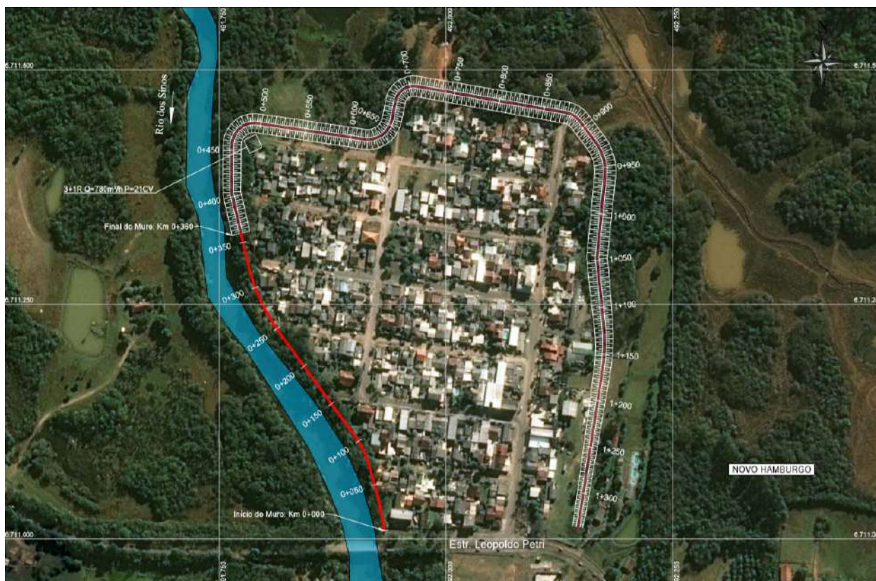
Figura 92 - Diques de proteção em Novo Hamburgo / Lomba Grande Fonte: Consórcio Metroplan Bacia do Rio dos Sinos
