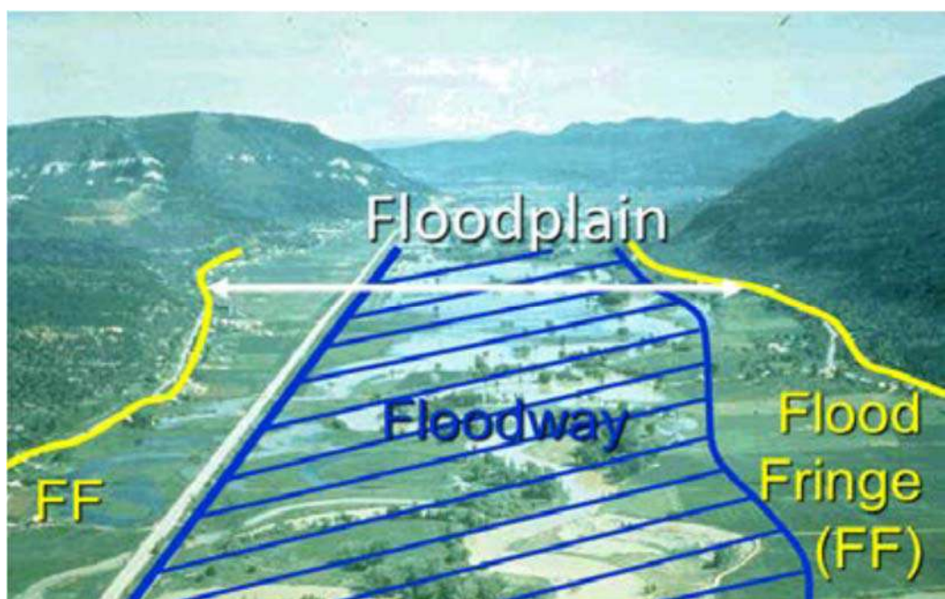
Figura 11 - Planície Inundação, Zona Passagem de Cheias e Zona com Restrições de Ocupação Fonte: DNR, 2014
