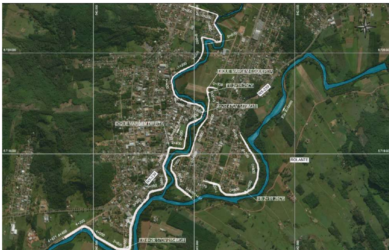
Figura 119 - Diques de proteção nos Arroio Areia e Rio Rolante e sistemas de bombeamento Fonte: Consórcio Metroplan Bacia do Rio dos Sinos
