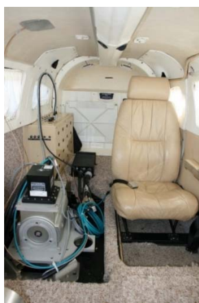
Figura 3 - Sistema Phase One, com a IMU do sistema de navegação (Fonte: Consórcio Metroplan Bacia do Rio dos Sinos)
