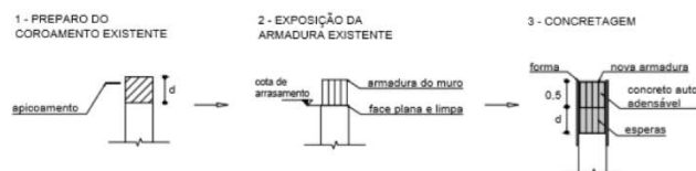
SEÇÃO-TIPO Elevação dos muros existentes Escala: s/escala
