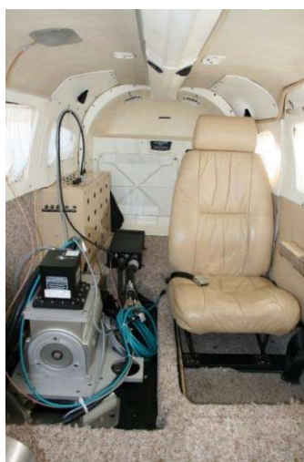
Figura 3 - Sistema Phase One, com a IMU do sistema de navegação (Fonte: Consórcio Metroplan Bacia do Rio Gravataí)
