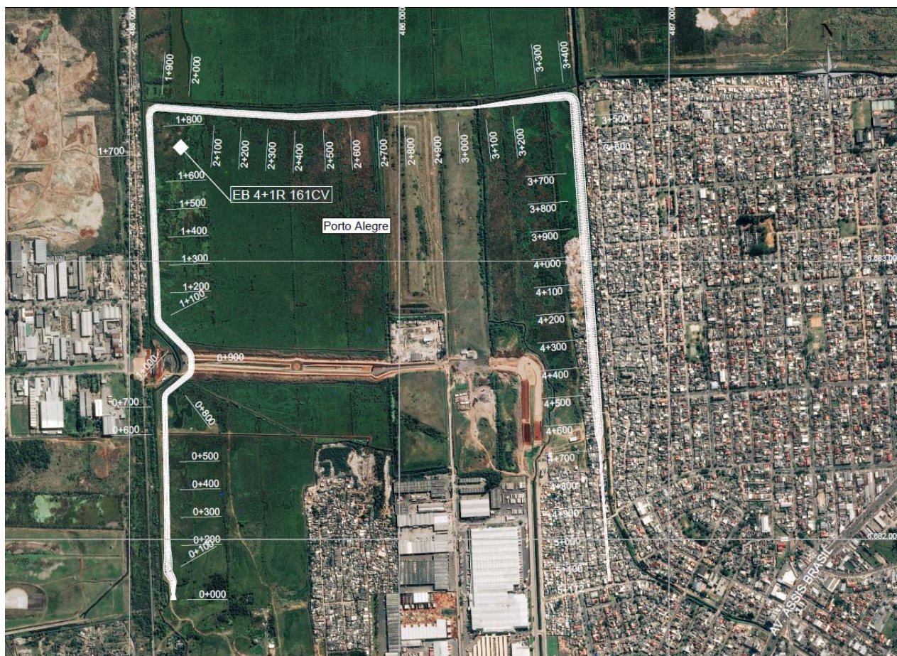
Figura 44 - Dique proposto no Bairro Sarandi em Porto Alegre e sistema de bombeamento. Fonte: Consórcio Metroplan Bacia do Rio Gravataí
