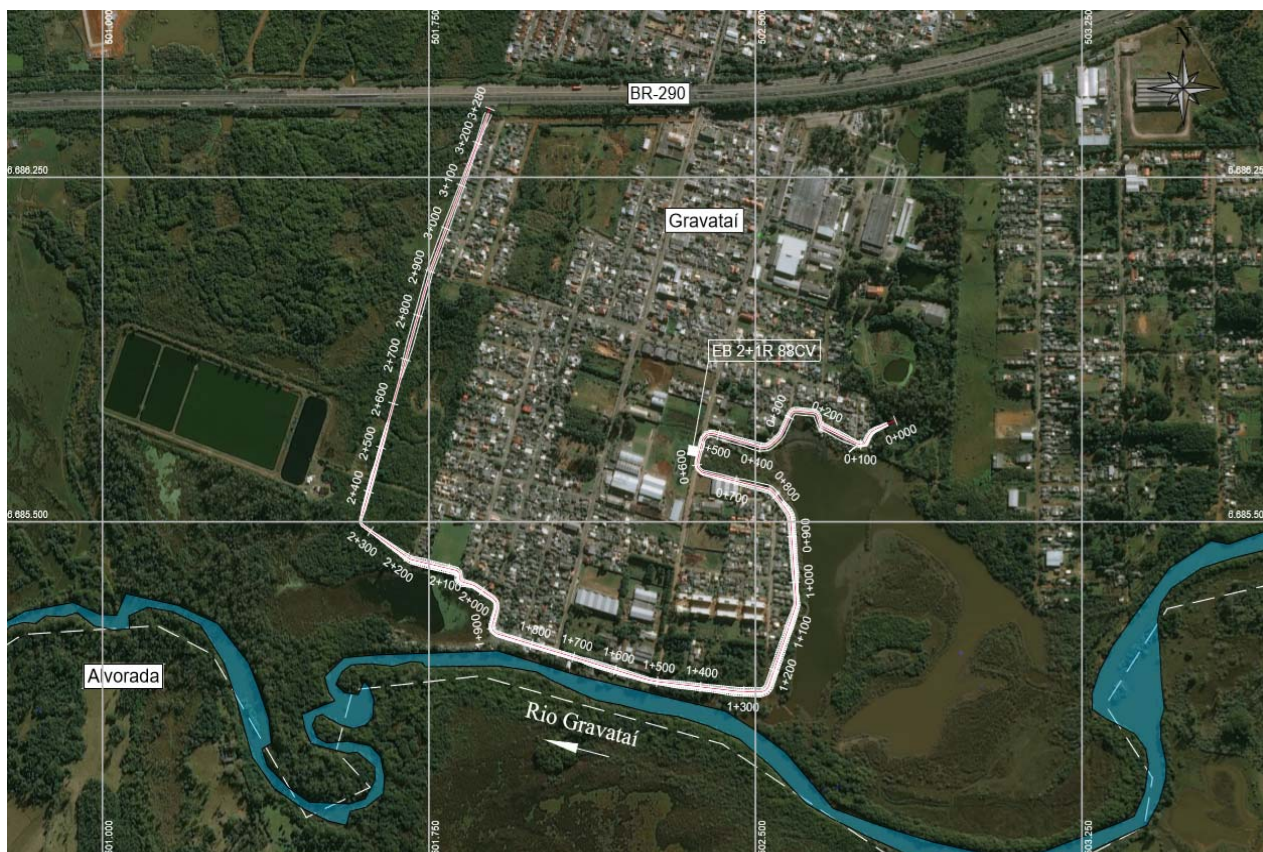
Figura 47 - Dique proposto no Bairro Caça e Pesca em Gravataí e sistema de bombeamento Fonte: Consórcio Metroplan Bacia do Rio Gravataí
