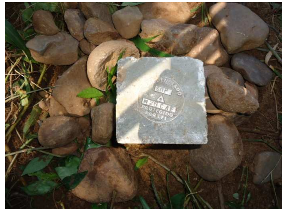
Figura 3.4: Marco da seção topobatimétrica S16
