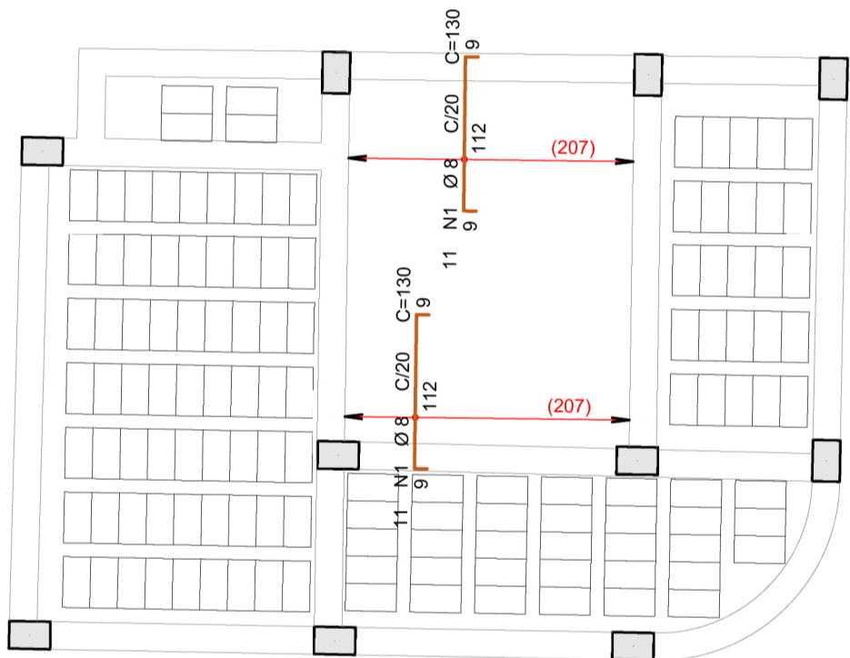
Detalhe genérico do alojamento de armaduras positivas
