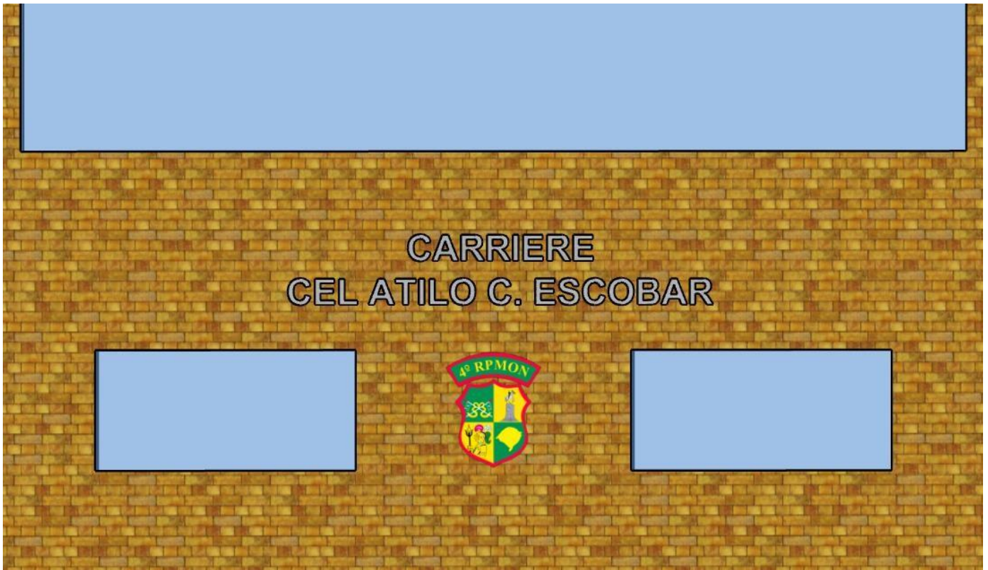
Brasão de ACM (1,08x0,90) instalado centralizado entre as janelas. Com iluminação led embutida atrás.
