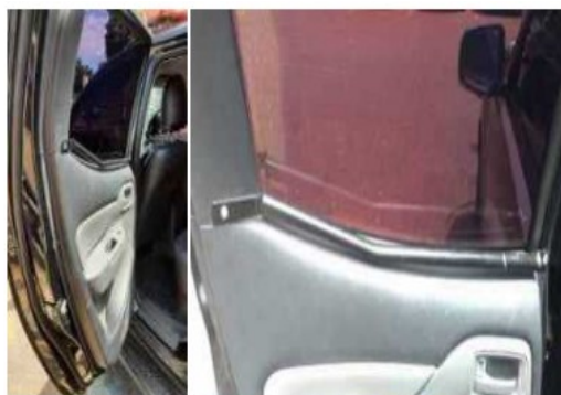
Fig.3: Barra de apoio metal: Vista interna
