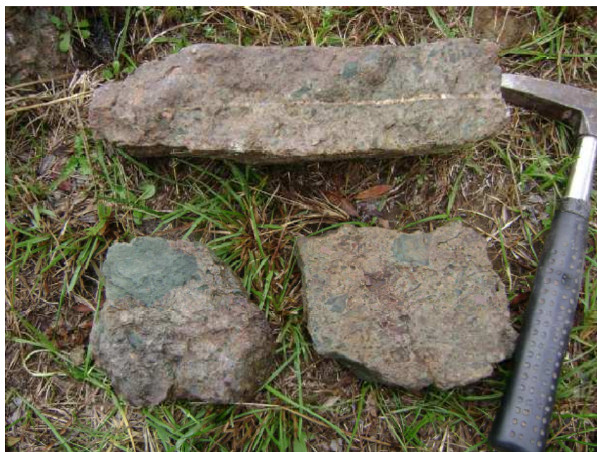
Figura 3.20: Amostras das rochas encontradas em campo: no alto Lapilito, abaixo e na esquerda Brecha e na direita Lapili Brecha (ombreira esquerda)
