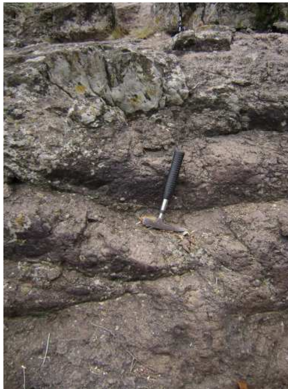
Figura 3.30: Disjunções horizontais (mesmo afloramento da Figura 3.29)
