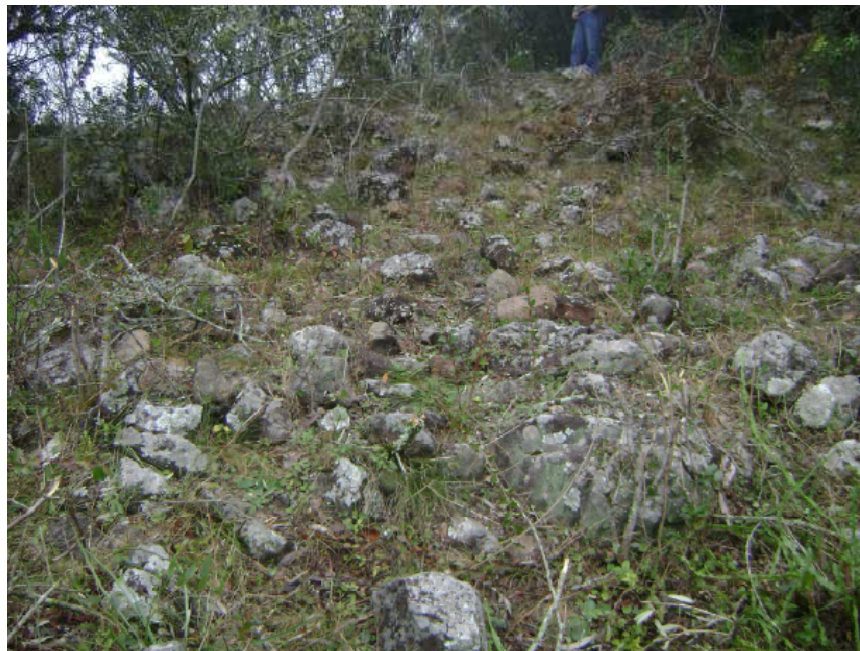
Figura 3.19: Tipo de afloramento típico da região com grande número de blocos e matacões (ombreira esquerda)
