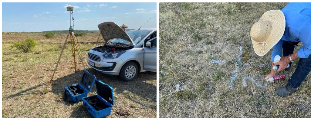
Figura 98 – Posicionamento do GPS e marcação de pontos de controle.
