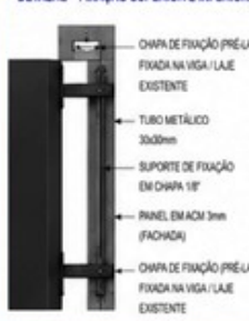
DETALHE – FIXAÇÃO SUPERIOR E INFERIOR
