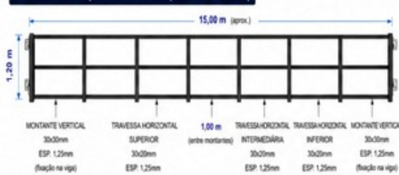
ESTRUTURA DE FIXAÇÃO – VISTA FRONTAL (SEM APOIO NO CHÃO)
