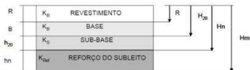
Figura 03. Dimensionamento de pavimento flexível
