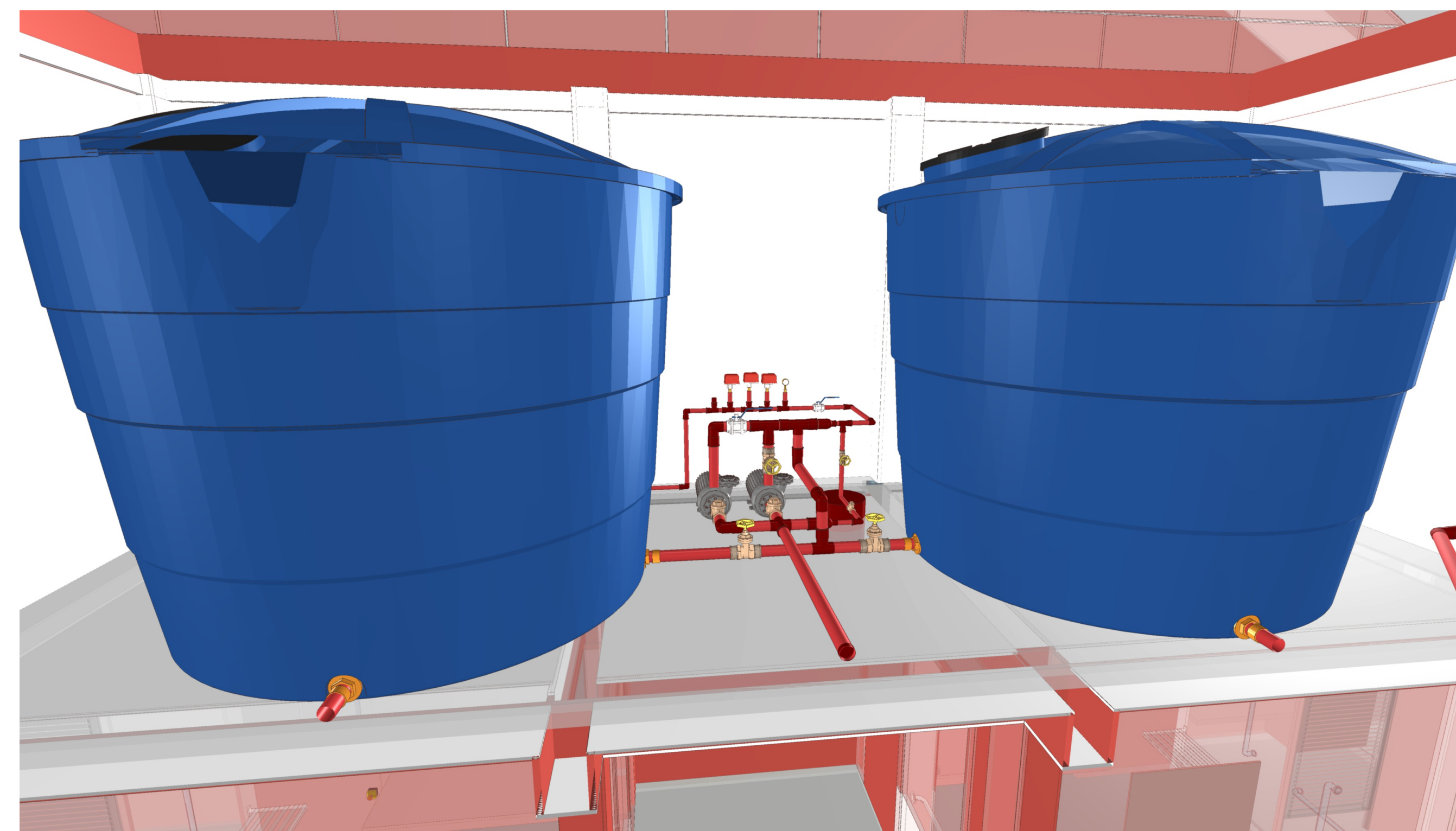
RESERVA TÉCNICA E CASA DE BOMBAS
