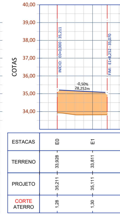
PERFIL ESTACIONAMENTO 04 Escala Horizontal 1:1000 Escala Vertical 1:100
