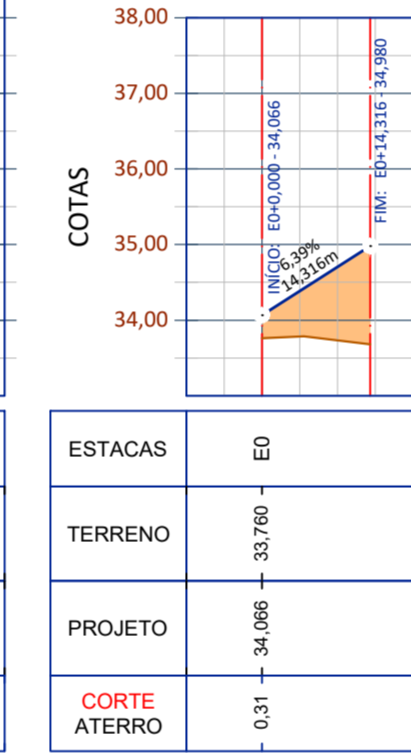
PERFIL ESTACIONAMENTO 05 Escala Horizontal 1:1000 Escala Vertical 1:100
