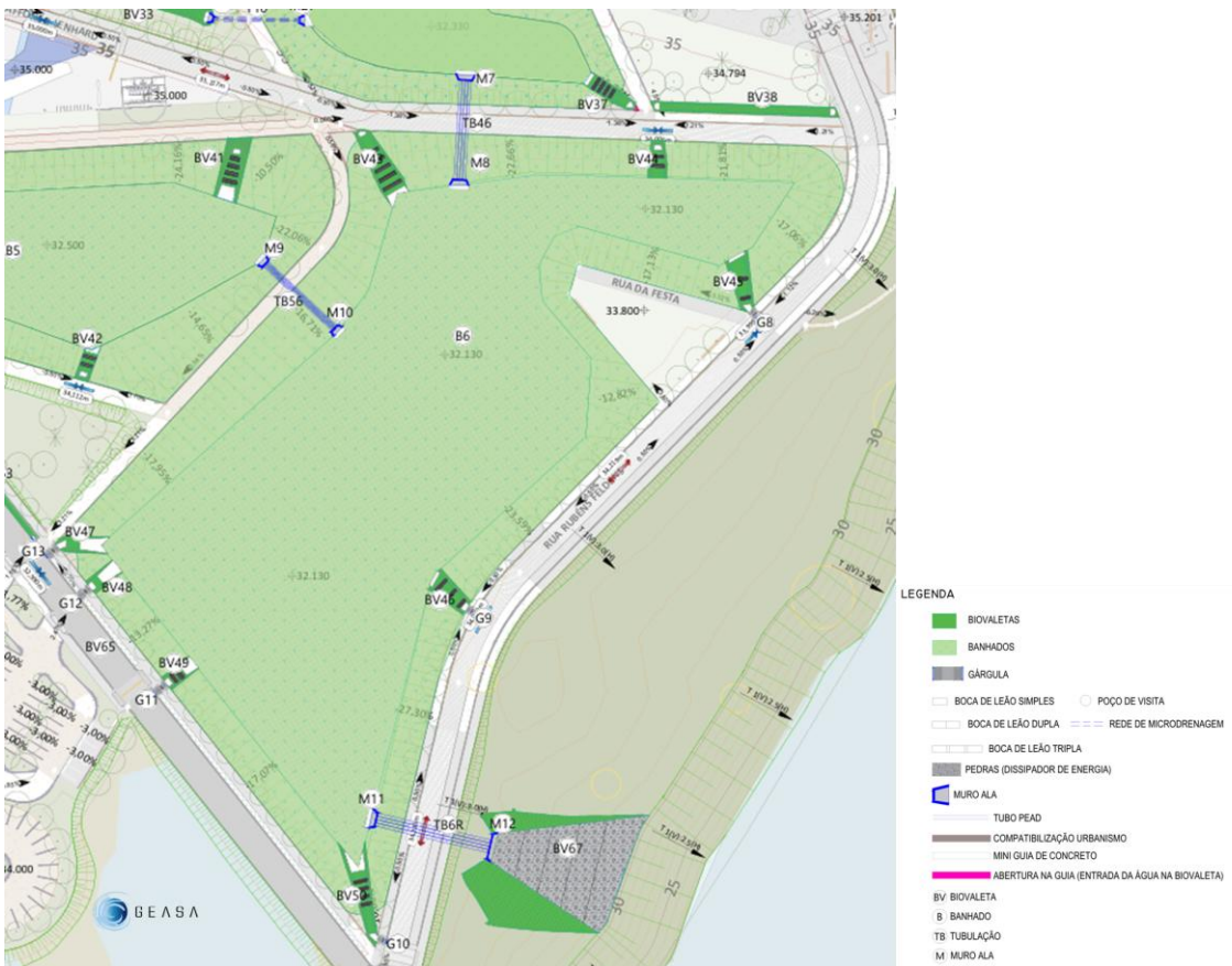
Figura 21 – Implantação do banhado 6 – B6, detalhes apresentados no documento 25001_PS-EX-DRE-101-IMPLANTAÇÃO GERAL-RO6. Geasa Engenharia, 2026.
