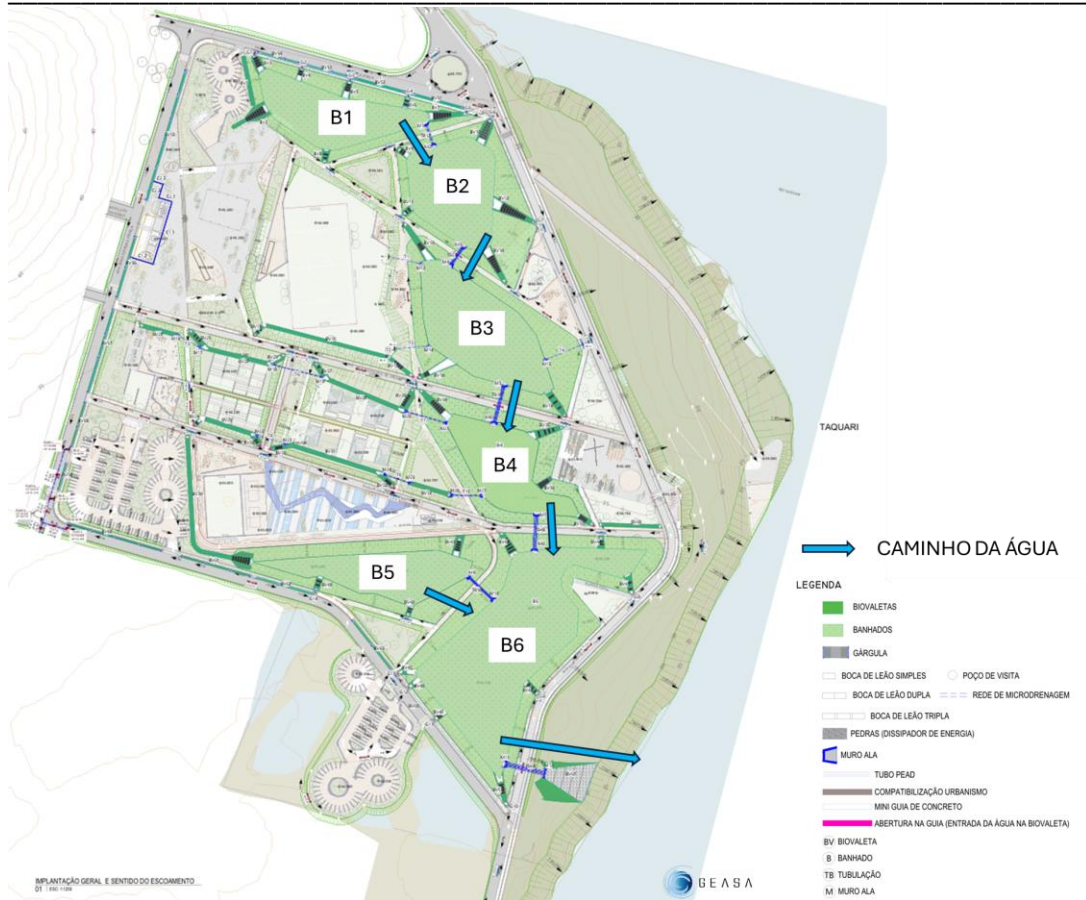
Figura 15 – Funcionamento do sistema de banhados, detalhes apresentados nos documentos 25001_PS-EX-DRE-135-AMPLIAÇÕES E PERFIS DAS TRAVESSIAS T10, T12 E T23-RO3; 25001_PS-EX-DRE-136-AMPLIAÇÕES E PERFIS DAS TRAVESSIAS T34 ET46-RO3; 25001_PS-EX-DRE-137-AMPLIAÇÃO E PERFL DA TRAVESSIA T6R-RO3. Geasa Engenharia, 2026.
