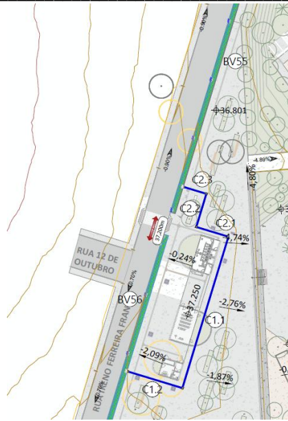
Figura 16 – Canaletas do centro comunitário
