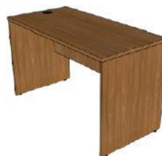
FIGURA 17 – PERSPECTIVA ISOMÉTRICA COM DETALHE DA SAIA E DO PASSA FIO
