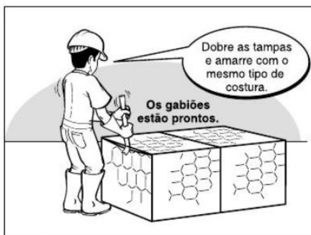
Figure 3: Detalhe da etapa de fechamento
