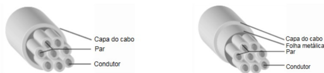
Figura 13-4 - (a) Cabo U/UTP (sem blindagem geral) e (b) Cabo F/UTP (com blindagem geral). Fonte: ABNT NBR 14565:2019.
