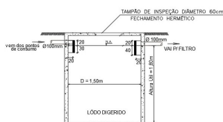
DETALHAMENTO FOSSA | CORTE AA
