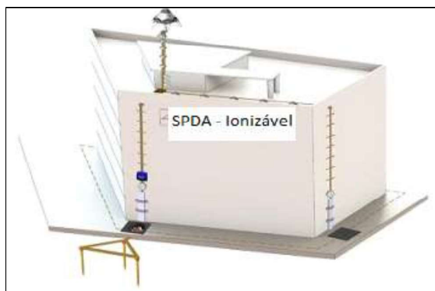
Sistema SPDA Tradicional, com captação por condutores em malhas, minicaptores e para-raios Franklin, diversos condutores de descida e aterramento em anel ao redor do perímetro do prédio.
