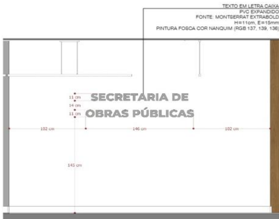
DETALHE - INSTALAÇÃO LETRA CAIXA esc. 1/25
