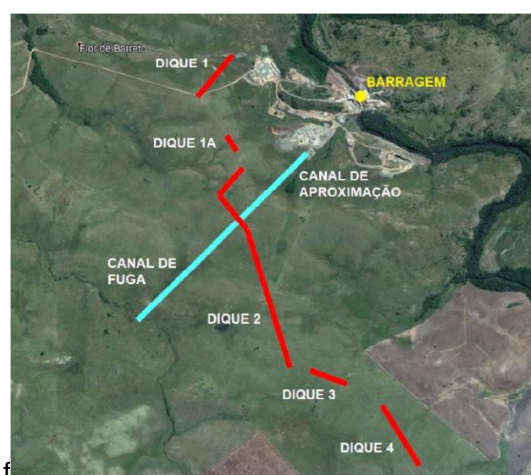
Figura 67 – Localização dos diques (vermelho) e demais estruturas (relatório Supervisão, 2020).
