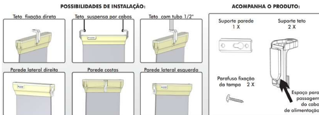
Tipologias de instalação e fixação equipamento da Luxpryme
