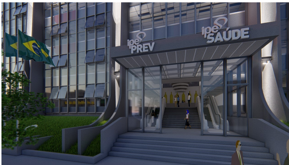
Figura 10: Ilustração de trecho junto ao acesso projetado para a iluminação do conjunto, neste caso ilustrado com o uso de iluminação na cor branca com o equipamento iluminando no sentido de baixo para cima (em direção ao topo da fachada) e de cima para baixo (em direção ao passeio público).
