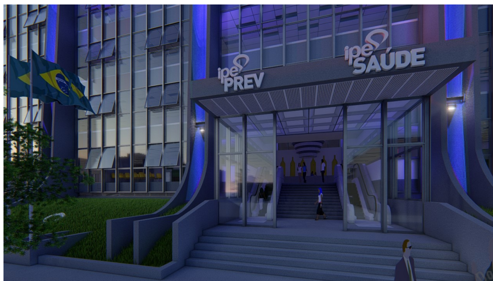
Figura 9: Ilustração de trecho junto ao acesso projetado para a iluminação do conjunto, neste caso ilustrado com o uso de iluminação na cor azul com o equipamento iluminando no sentido de baixo para cima (em direção ao topo da fachada) e de cima para baixo (em direção ao passeio público).
