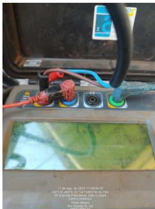
Figura 11 – Leitura de resistência de aterramento no patamar do Armazém A6.
