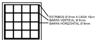
SAPATAS VISTA SUPERIOR ESCALA 1/25
