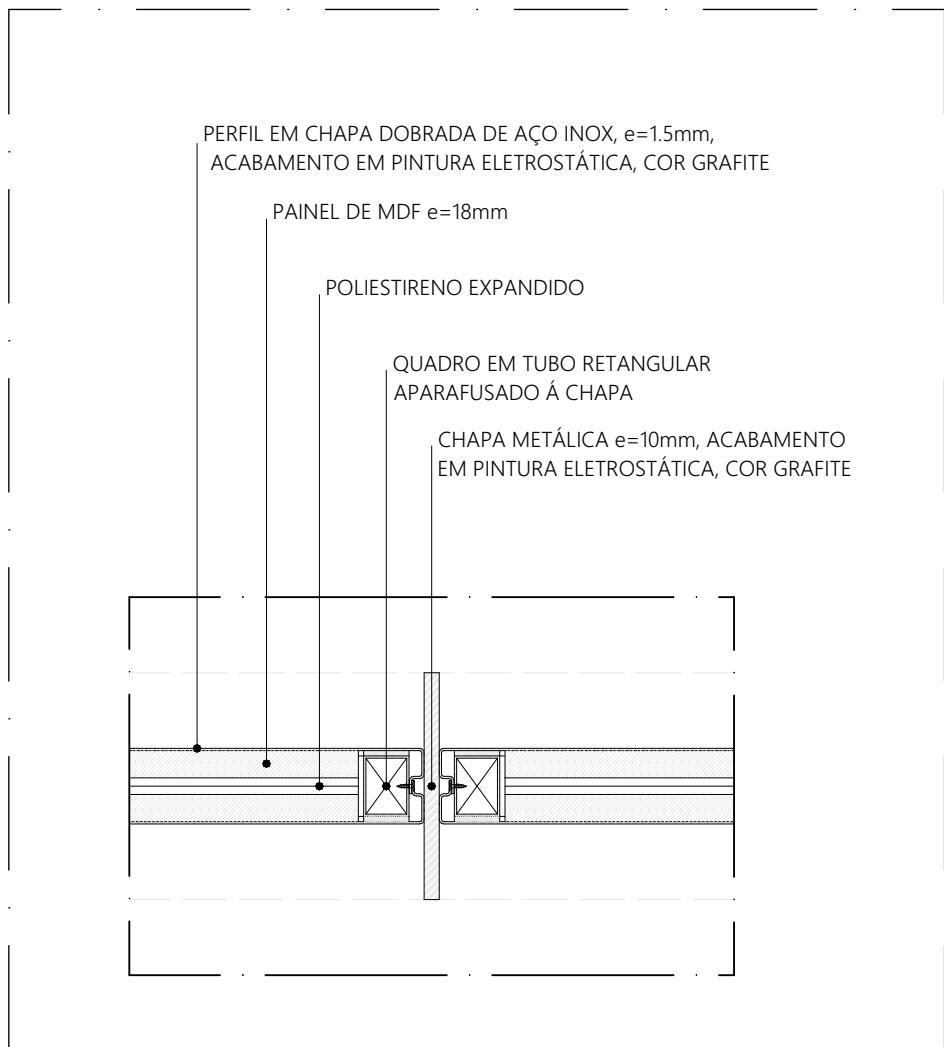
DETALHE TÍPICO ARREIMATE PAINEL FIXO - PAINEL FIXO (AÇO) ESCALA 1:5
