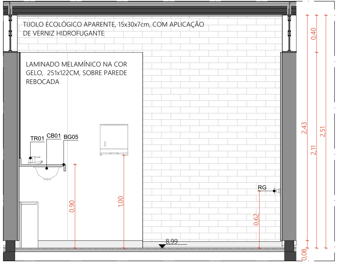
VISTA 02 | SANIT. FEMININO 01 | PAVILHÃO DUPLO ESCALA 1:25
