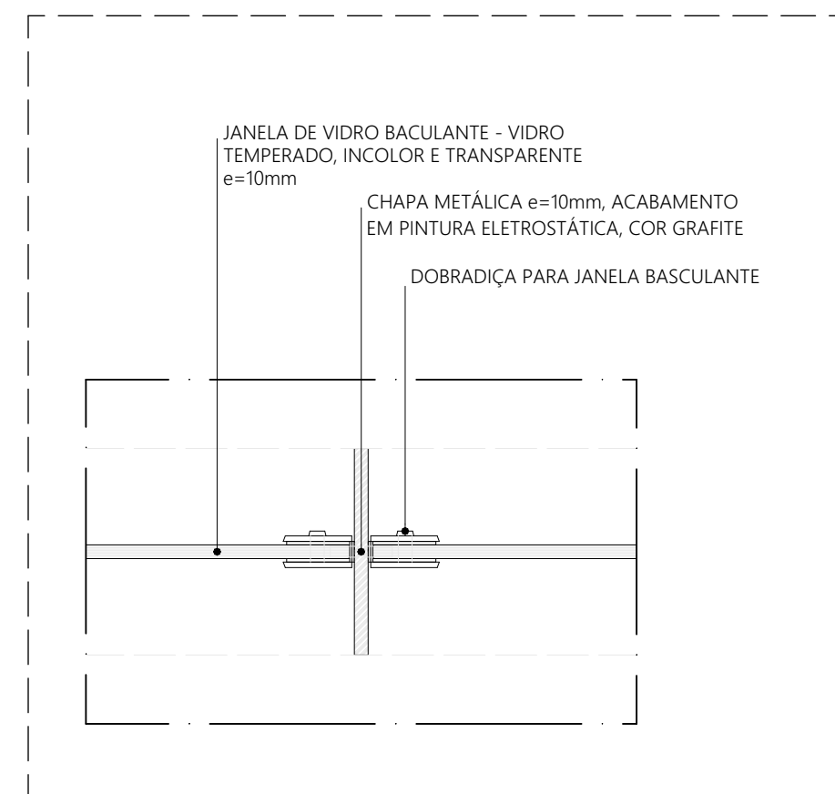
DETALHE TÍPICO ARREIMATE JANELA BASCULANTE - JANELA BASCULANTE ESCALA 1:5
