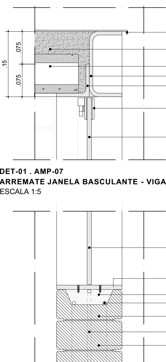
DET-02 - AMP-07 ARREIMATE JANELA BASCULANTE - ALVENARIA ESCALA 1:5
