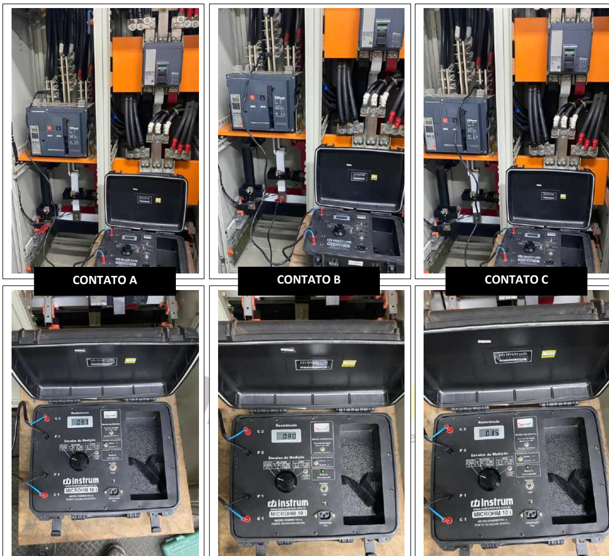
Figura 15 - Resistência de contato QGBT
