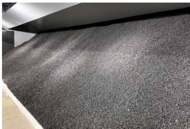
Figura 2: Anteparo de aço com granulado de borracha (elastômero)
