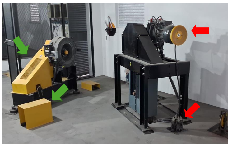
Imagem 3 – Máquinas com e sem proteção
