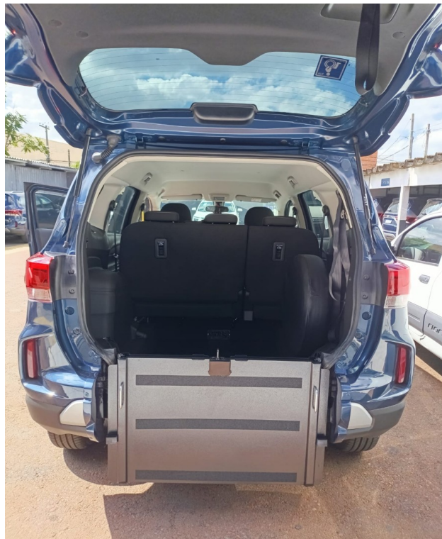
Fig. 5- Detalhe da tampa traseira e da rampa
