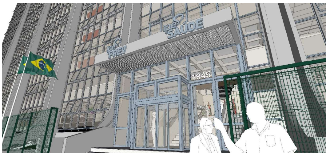
Imagem 01: Imagem da Esquadria composta por dois conjuntos de portas de aproximação a serem instaladas
