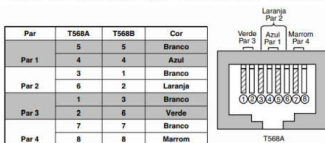
Figura 1- Configuração de terminação dos cabos junto às TT e Patch Panel
