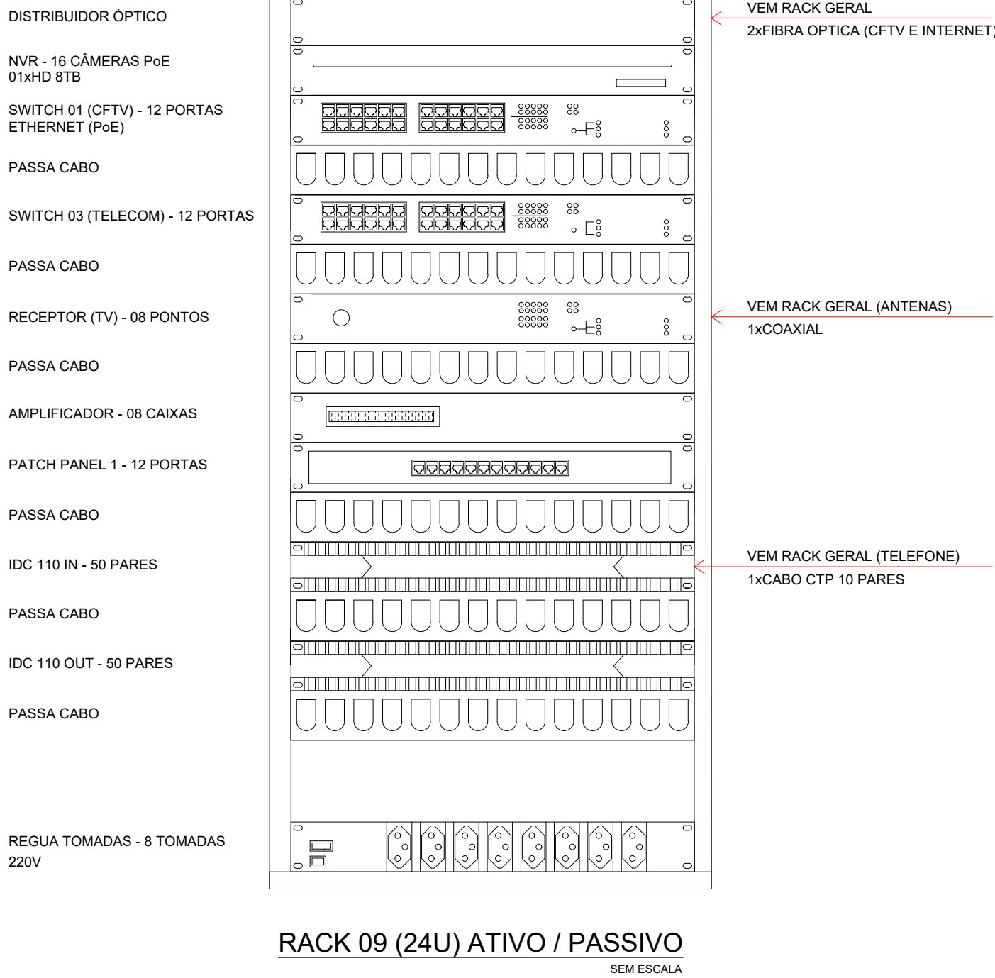
RACK 09 (24U) ATIVO / PASSIVO SEM ESCALA
