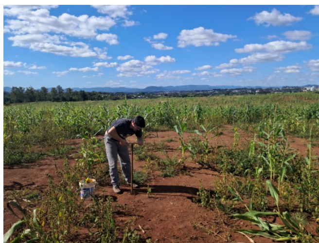
Fotografia 02: Realização do ensaio de infiltração E1.
