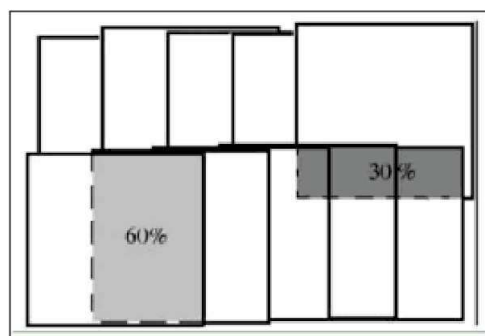
Figura 5 - Exemplo ilustrativo do bloco fotogramétrico, com as sobreposições longitudinais e laterais.
