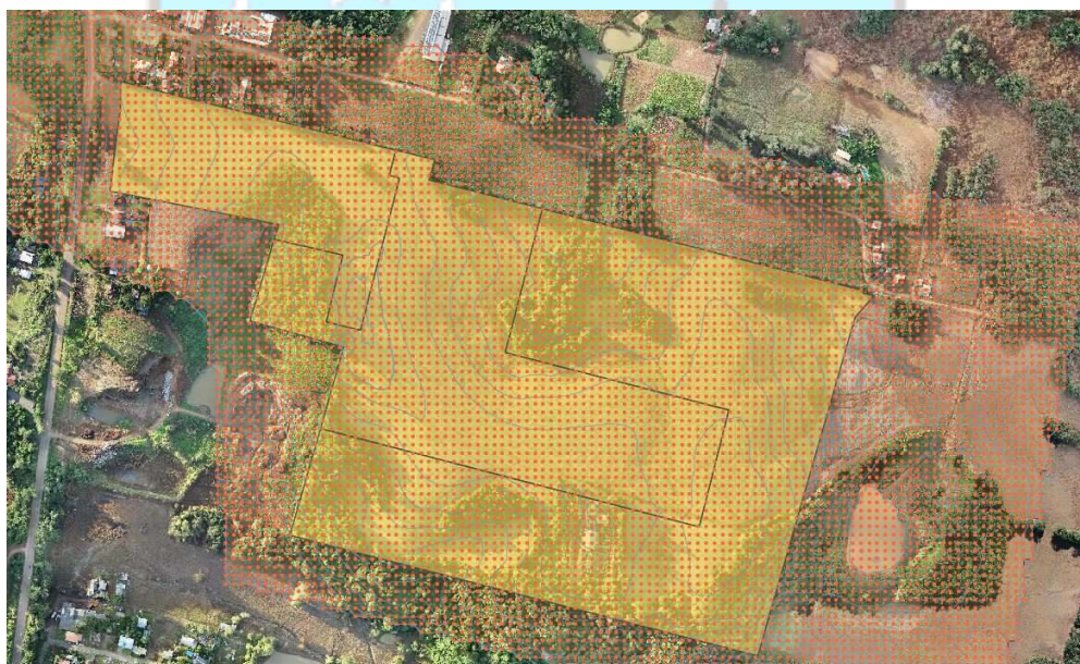
MALHA DE PONTOS TRIDIMENSIONAIS A CADA 5m
