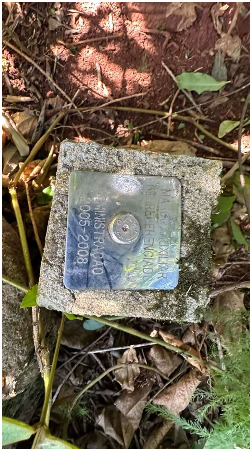
Marcos auxiliares encontrados no perímetro da área
