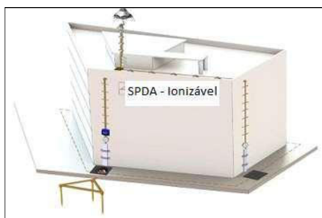
Sistema SPDA Moderno, com captação com um Para-raio PDI com captor ionizante não-radioativo, dois condutores de descida e dois aterramentos locais.
