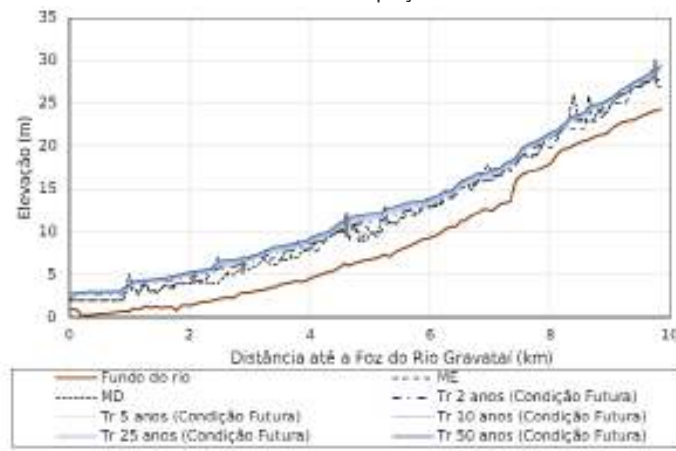
Figura 24. Perfil das linha de água no arroio Santo Agostinho para diferentes Tempo de Retorno para condição atual de uso e ocupação do solo
