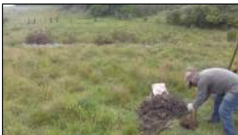
Foto 5. Abertura de poço para coleta de amostra indeformada com escavadeira F-AB04
