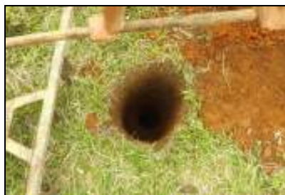
Foto 3. Primeiro metro com diâmetro maior para coleta de amostra indeformada para determinar Densidade e Umidade natural
