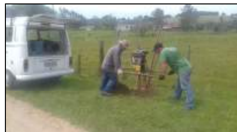
Foto 4. Perfuração com trado mecânico no F-AB01
