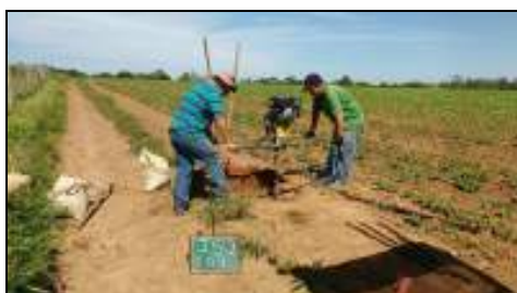
Foto 7. Perfuração com trado mecânico no F-JS02.04
