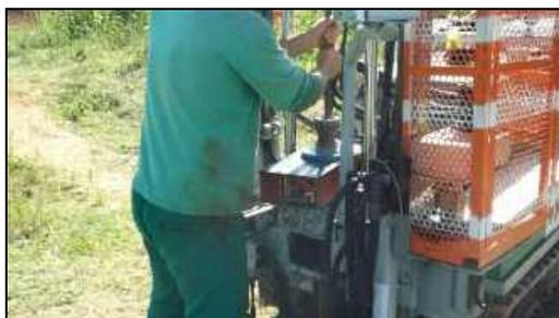
Foto 19. Rotação manual da palheta por 10 voltas consecutivas, obtendo-se a resistência não drenada do terreno nas condições de solo amolgado.
