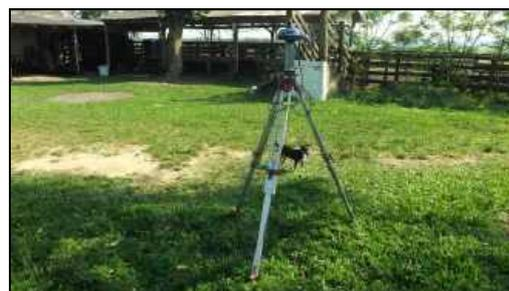
Foto 26. Base do GNSS transportada para fazenda localizada em alvorada para amarração dos furos localizados nas proximidades.
