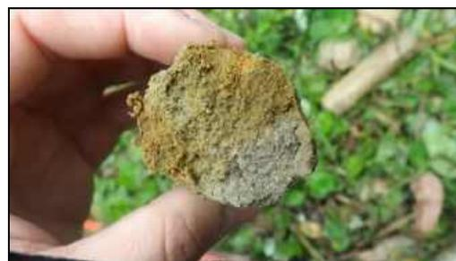
Foto 6. Amostra de solo arenoso, cinza amarelo, retirada do bico do amostrador.
