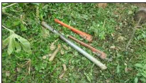
Foto 5. Amostrador padrão, martelo padronizado 65 kg e chaves grifo para o auxílio da retirada das hastes.
