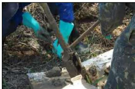
Foto 23. Retirada do solo no amostrador concha.
