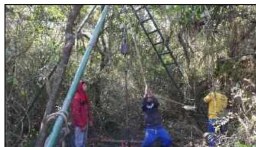
Foto 4. Cravação do amostrador padrão até completar os 45 cm de penetração por meio de impactos caindo de 75 cm de altura.
