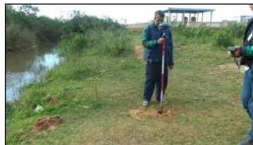
Foto 28. Rover transportado para amarração dos furos (SP-DPR.18).
