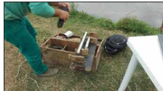
Foto 12. Preparação da ponteira cônica para ensaio CPTU.
