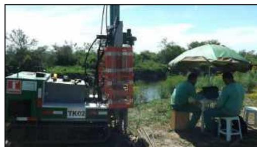
Foto 18. Acompanhamento em tempo real da resistência do solo não drenada aplicando torque a uma rotação de 6 graus/minuto.
