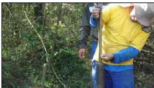
Foto 3. Marcação com giz na haste no segmento de 45 cm, dividido em trechos 15 cm.
