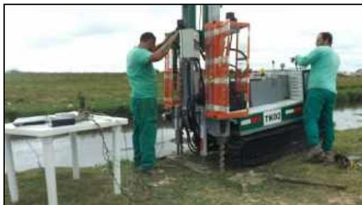
Foto 11. Estabilização do Penetrômetro a partir de trados helicoidais cravados no solo.
