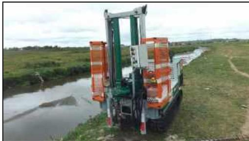
Foto 9. Sistema pesado sobre esteiras (Penetrômetro GEL - 300), para ensaio CPTU e Vane Test.
