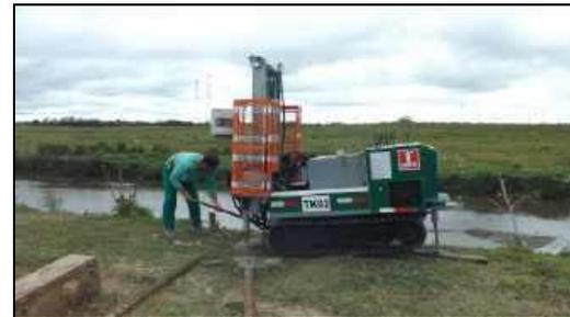
Foto 10. Preparação do terreno para início do ensaio CPTU.
