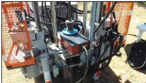
Foto 15. Unidade de torque elétrica acoplado no Penetrômetro para ensaio de palheta.
