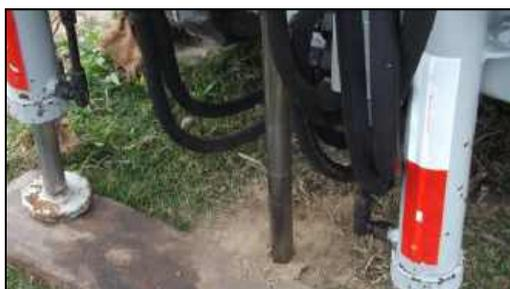
Foto 13. Início do ensaio e cravação da ponteira a 2 m/s.
