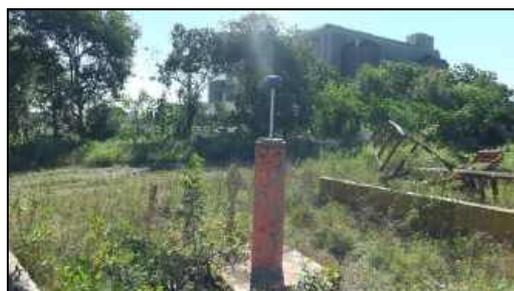
Foto 25. Base do GNSS no marco geodésico do IBGE, localizado na usina de asfalto de Porto Alegre para amarração dos furos.
