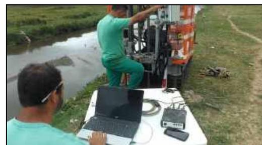
Foto 14. Acompanhamento em tempo real da cravação da ponteira, observado a resistência de ponta, atrito lateral, poro-pressão e razão do atrito.
