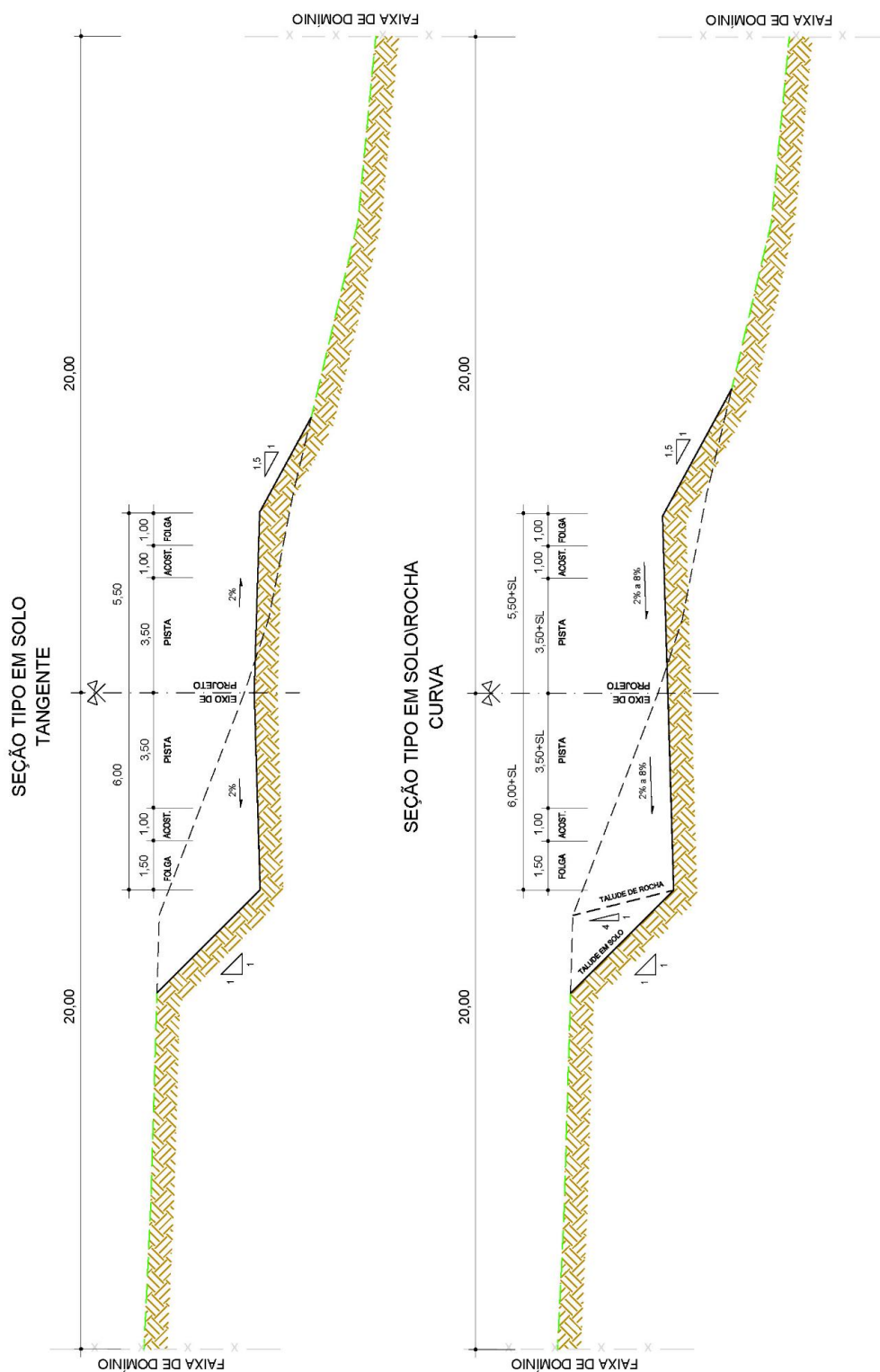
Figura 3 – Seção tipo de terraplenagem
