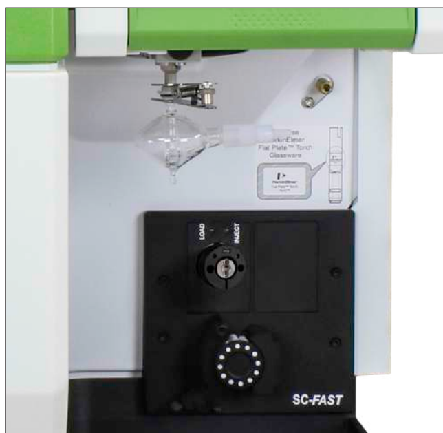
Módulo base integrado ao ICP OES Avio 500
