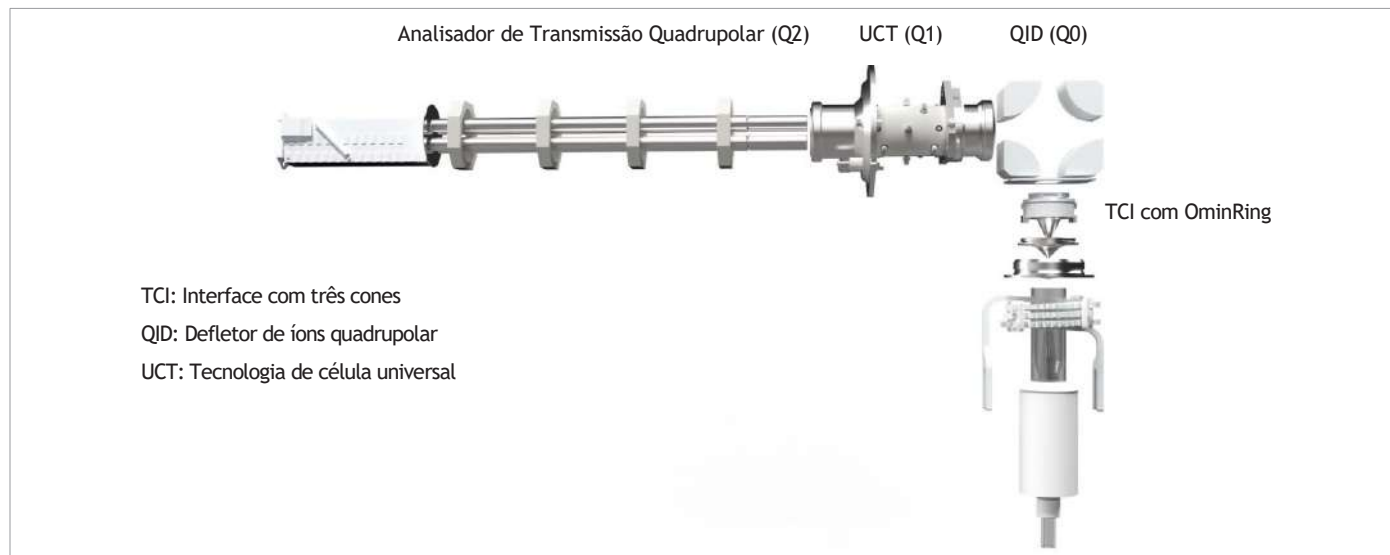
Figura 8. Óptica iônica do ICP-MS NexION 2200 com três quadrupolos designados por Q0, Q1 e Q2 respectivamente.
