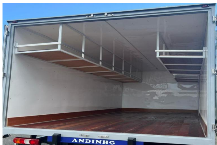
Isolamento interno em EPS com fibra de vidro (opcional: prateleiras superiores)
