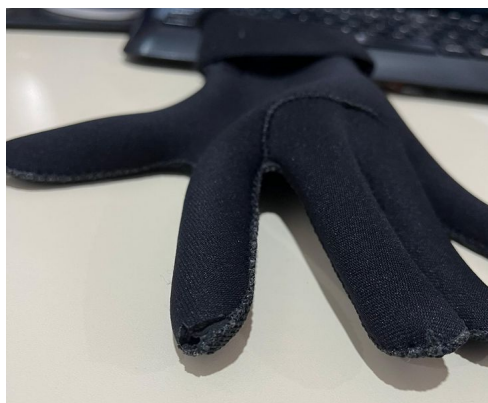
Imagem 01 – Cola aparente nas junções das costuras e desgaste na ponta do dedo após experimentar
